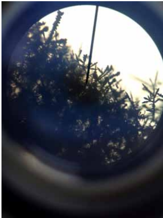
Fig.2a- Microfotografia de uma Reação redox entre íons chumbo (II) e magnésio. Microscópio Ótico Composto (M.O.C.) (40x).
