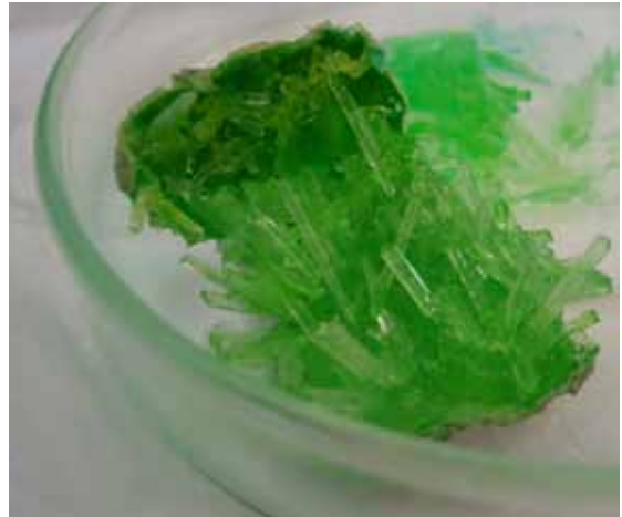
Fig.6a- Fotografia de crescimento de cristais de KNO_3 (nitrato de potássio) com corante alimentar verde.
